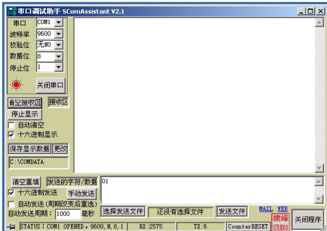
7. 在发送区中写 “ 01 ” , 点手动发送 , 你将看到 L1 点亮 , L2 到 L8 熄灭 ( 代表二进制的 0000001 ); 此时你把 SW8 拨到低 , 那么在接收区看到不断出现 “ 01 ”
