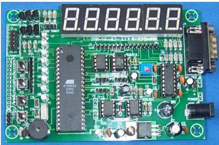
图 1 具有仿真功能的实验板
