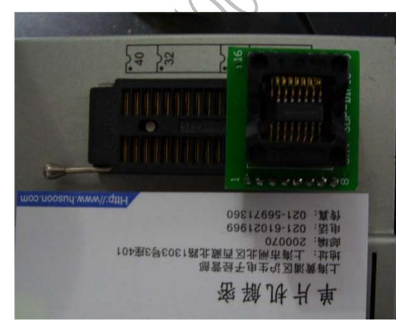
5. 连接好电源和并口,注意使用配套的电源,否则会烧毁烧写器
